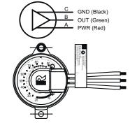
REMOTE READY HALL EFFECT MODULE PIN OUTPUT DIAGRAM
