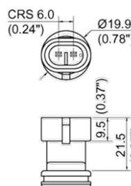
2 WAY PACKARD METRI-PACK 150 SERIES CONNECTOR
